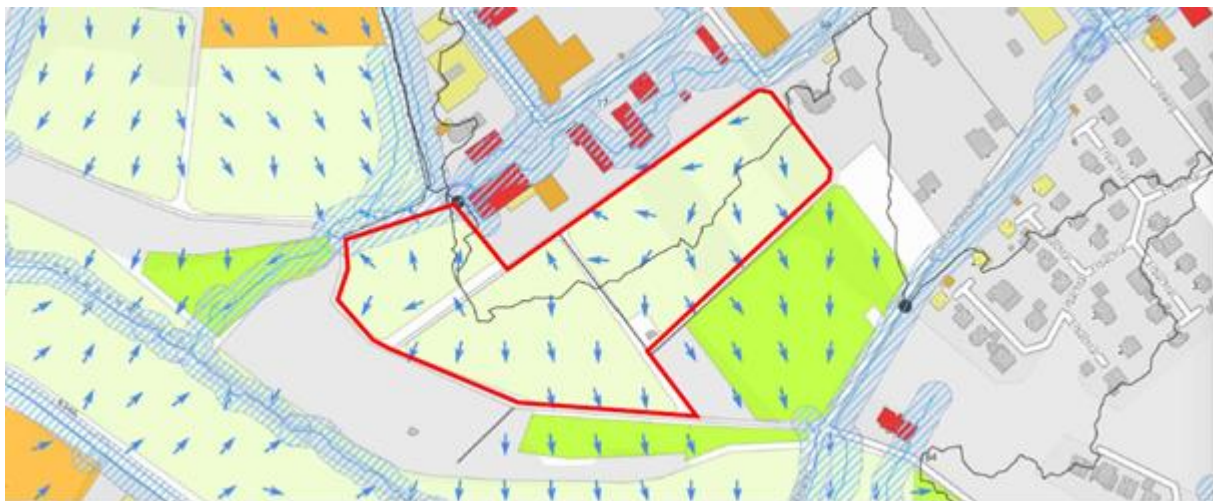
Abbildung 13: Ausschnitt Kommunale Fließpfadkarte für das Plangebiet, Quelle: Starkregenviewer Hessen HLNUG, 2025, modifiziert: Kraus 2026
