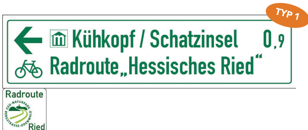
Abb. 3-4: Beispiel für die Ausweisung einer Radroute mit Zielwegweiser und Einschubplakette.
