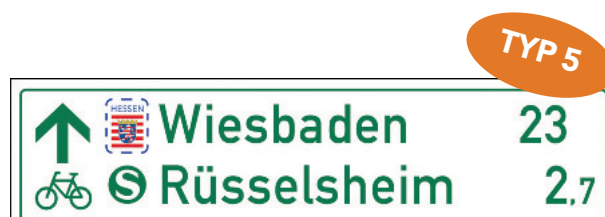
Abb. 3-10: Radwegweisung zu einem Hessischen Radfernweg; Typ Tabellenwegweiser
