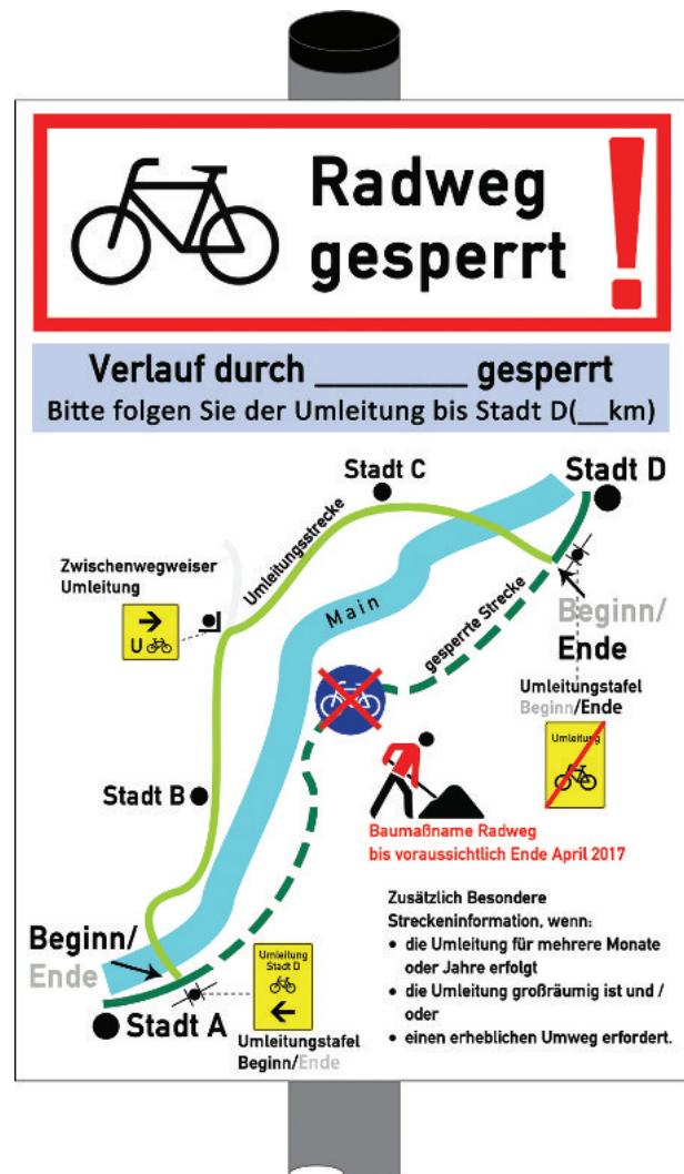
Abb. 3-14: Umleitungstafel am Beginn der Umleitung
