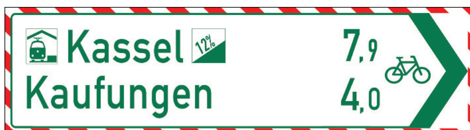
Abb. 3-15: Zielwegweiser für längerfristige Umleitungen
