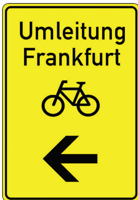
Abb. 3-11: Umleitung auf wichtigen Haupttradrouten: Zwischenwegweiser mit Zielangabe
